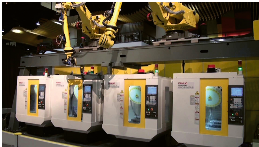
Figure 1.3: Cellule associant 4 centres d'usinage et 2 robots de chargement-déchargement (Fanuc Robotics).
